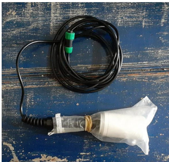
Figura 2: Preparação da ponta de prova de OD para transporte.
