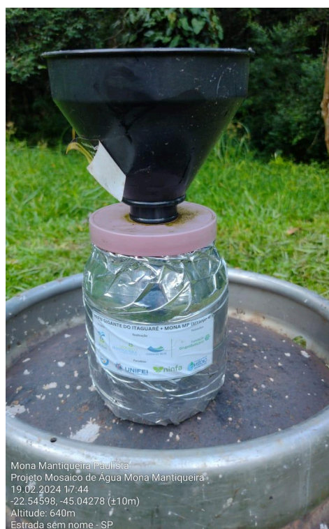
Figura 11: Coletor de chuva instalado no arranjo 4.
